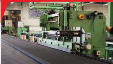
L'incollaggio a caldo è un processo in cui le membrane EPDM sono collegate in modo omogeneo tra loro per formare fogli di grandi dimensioni mediante vulcanizzazione. Un'altra pressione, un tempo e una temperatura preimpostata garantiscono che venga creata una connessione completamente a prova di perdite. Le condizioni di fabbrica e il controllo costante della qualità nel nostro stabilimento di produzione garantiscono un elevato livello di qualità.
